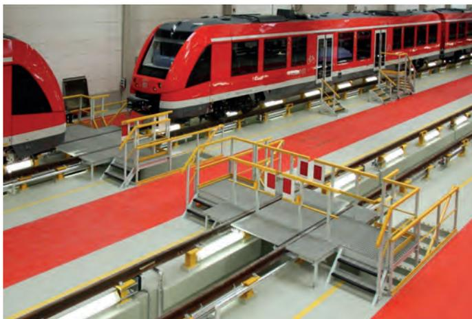
Abb 1: GFK/Gleisübergänge und Arbeitspodeste im DB Regio Werk Köln-Deutzerfeld
