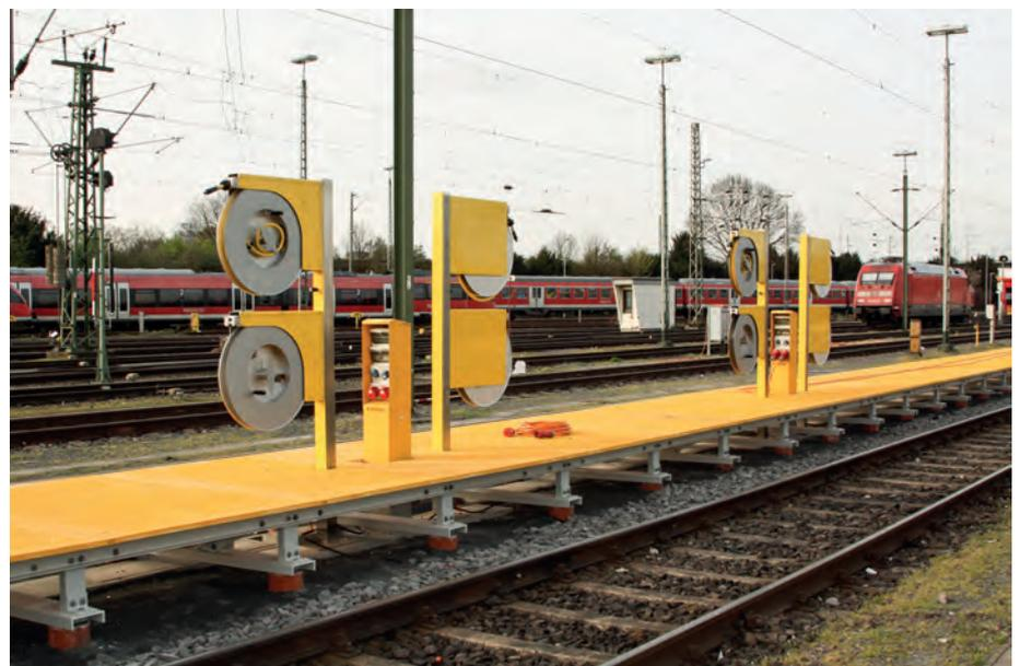
Abb 4: GFK-Einstiegspodest mit Aufroller für Druckluft und Stromversorgung
