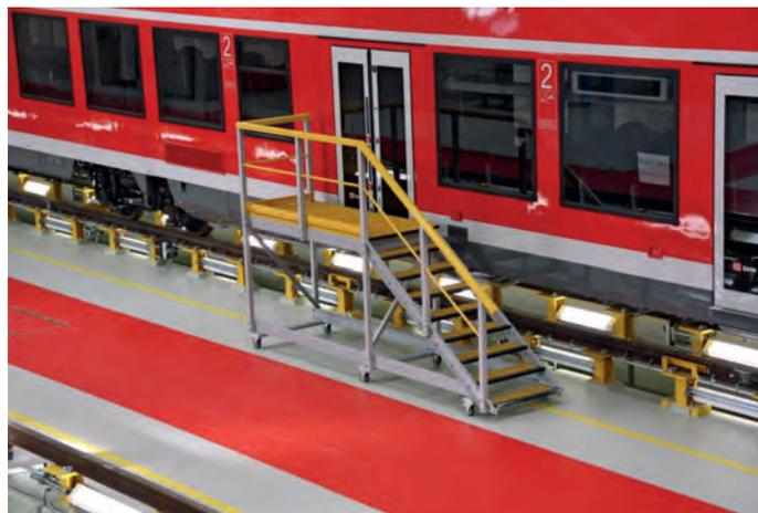
Abb 2: GFK/Arbeitsbühne (verfahrbar) im DB Regio Werk Köln-Deutzerfeld
