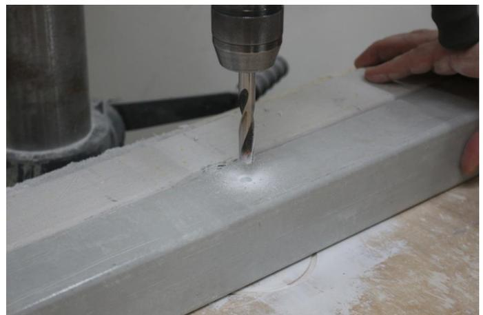
Bohren von GFK Profilen
